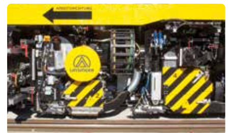
Fräseinheit mit nachgeschalteter Umfangsschleifeinheit für höchste Oberflächenqualität
